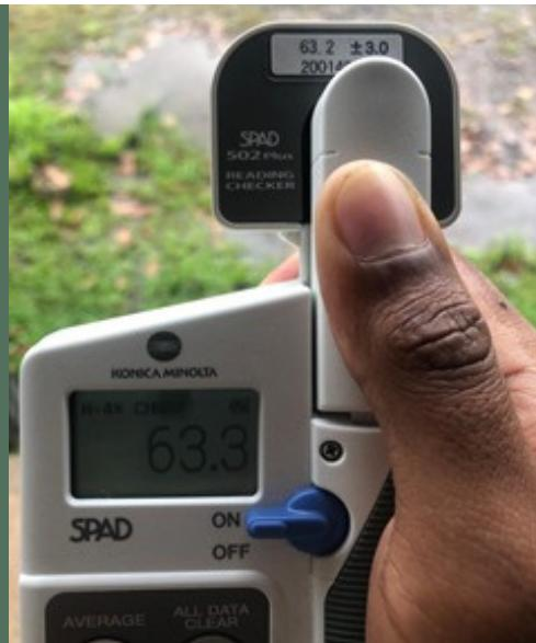
El SPAD (Soil Plant Analysis Development) es un medidor para evaluar la concentración de clorofila en las hojas de las plantas. Este dispositivo permite estimar indirectamente el contenido de nitrógeno en las plantas, ya que la clorofila está estrechamente relacionada con el estado nutricional del cultivo.
